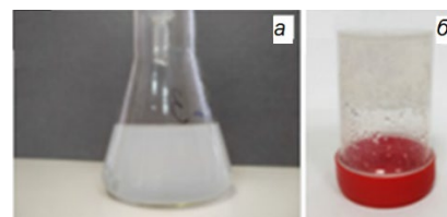
Рис. 2. Золь (а) и гель (б), получаемые с применением растворов пептизаторов
