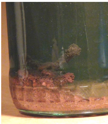
Рис. 6. Осадок после реакции со стальным стержнем
