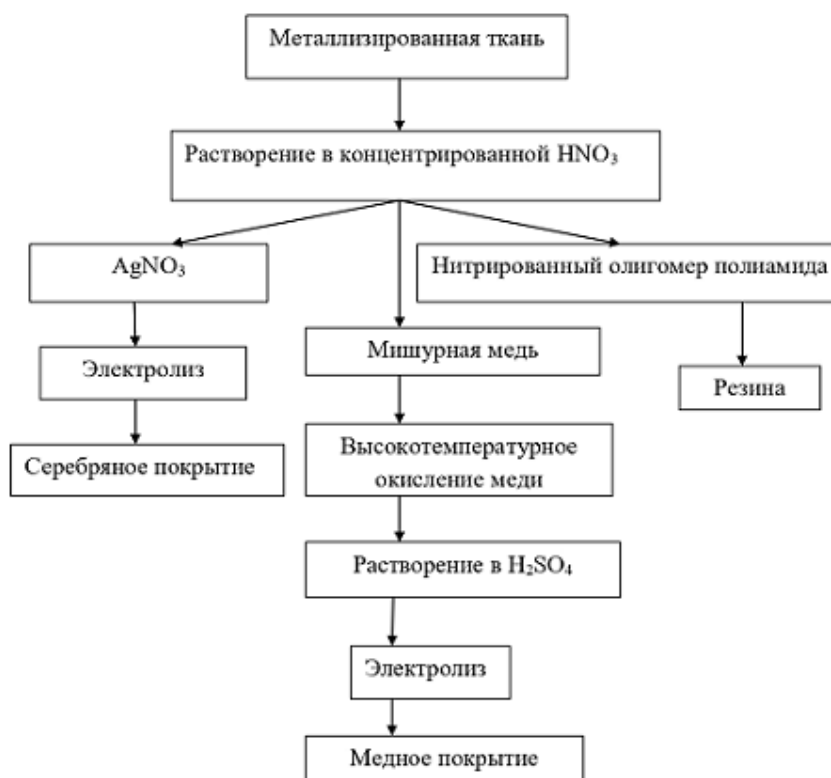
Рис. 3. Технологическая схема извлечения металлов из металлизированных тканей электрохимическим способом
