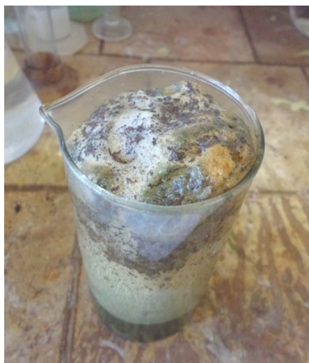
Рис. 4. Процесс выделения водорода по всей поверхности магниевой стружки Рис. 5. Осадок после реакции со стружкой
