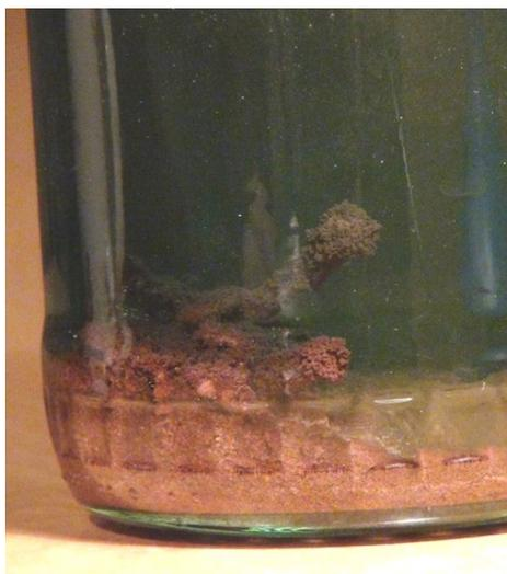
Рис. 6. Осадок после реакции со стальным стержнем
