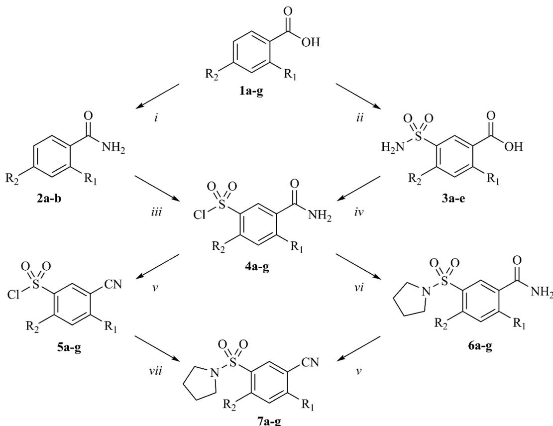
*i*: (1)  $\text{SOCl}_2$ , ДМФА; (2) MeCN,  $\text{NH}_2$  (25% водный раствор); *ii*: (1)  $\text{HSO}_3\text{Cl}$ ,  $140^\circ\text{C}$ , 2 ч; (2)  $\text{NH}_2$  (25% водный раствор); *iii*:  $\text{HSO}_3\text{Cl}$ ,  $70^\circ\text{C}$ , 2 ч; *iv*:  $\text{HSO}_3\text{Cl}$ ,  $90-100^\circ\text{C}$ , 1-1.5 ч; *v*:  $\text{POCl}_3$ ,  $90^\circ\text{C}$ , 30 мин; *vi*: (1) MeCN, пирролидин; (2) HCl; *vii*: MeCN, пирролидин.
