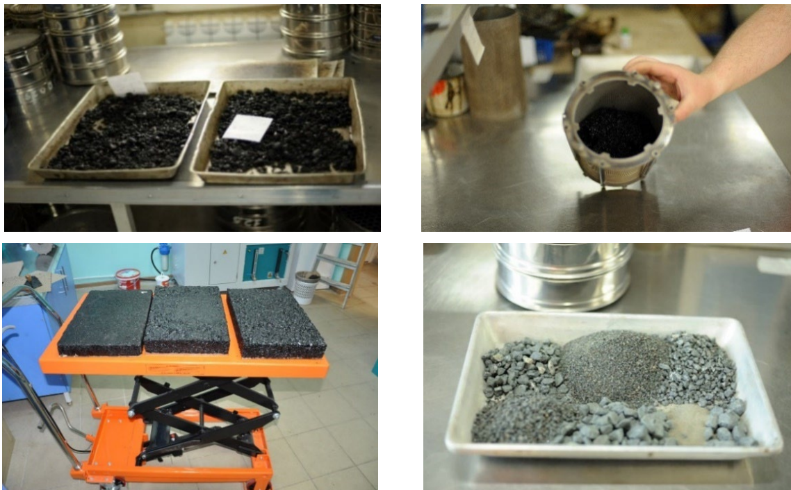
Рис. 4. Лабораторные испытания стандартных образцов асфальтобетона по ГОСТ Р 58406.2-2020 Fig. 4. Laboratory tests of standard asphalt concrete samples according to GOST R 58406.2-2020
