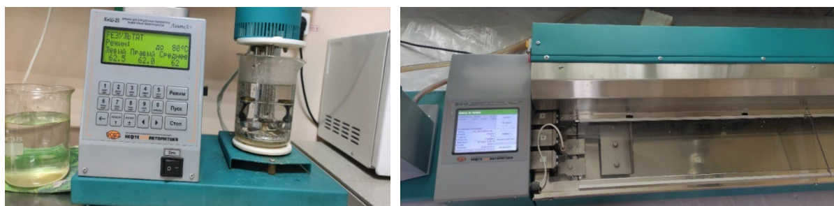
Рис. 2. Лабораторные испытания битума нефтяного дорожного БНД 70/100
