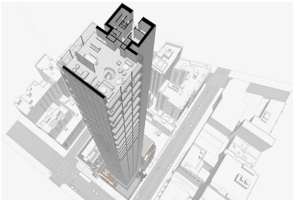
Рис. 4. Разрез 3D модели здания 262 на 5 авеню; видны ядро и несущие стены
