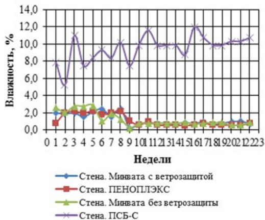
Рис. 2. Изменение относительной влажности утеплителей в течение отопительного периода
