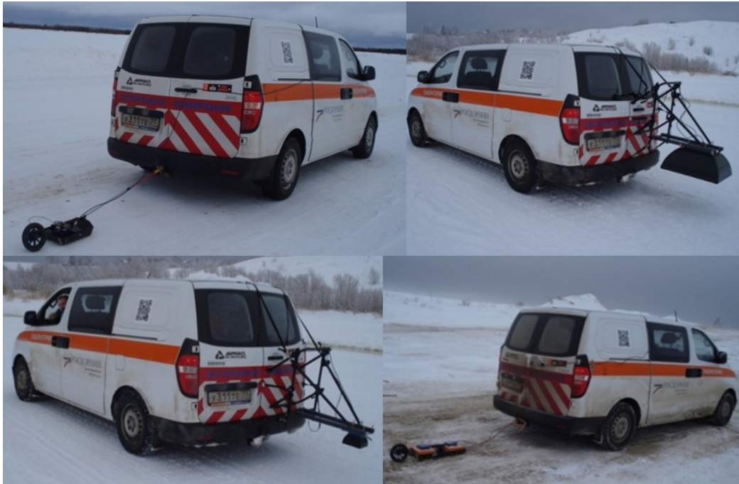
Рис. 3. Дорожная лаборатория с различными антенными блоками (АВ-1700, АВ-400Р, АВ-1700R и АВ-400) на ледовых переправах
