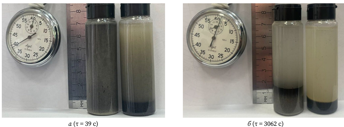
Рис. 4. Вид суспензий после гомогенизации встряхиванием и фотофиксации процесса седиментации спустя 39 (а) и 3062 с (б) от его начала
