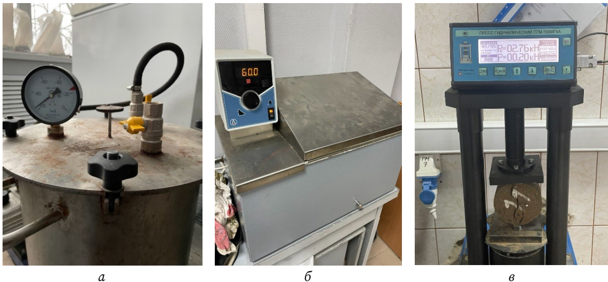
Рис. 1. Процесс испытания опытных образцов: a – водонасыщение; б – термостатирование; в – испытание на гидравлическом прессе
