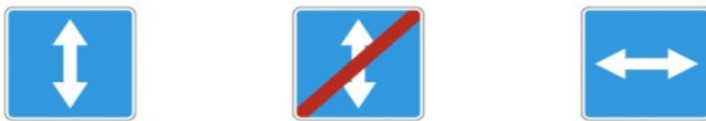
Рис. 3. Технические средства организации реверсивного движения представлены в последовательности (5.8; 5.9; 5.10) [29]
