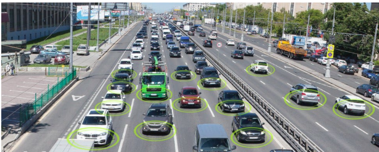
Рис. 2. Отслеживание транспортного потока по средствам камеры [27]
