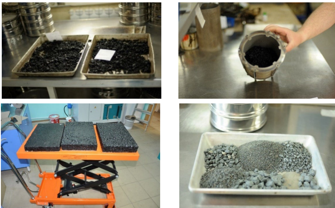
Рис. 4. Лабораторные испытания стандартных образцов асфальтобетона по ГОСТ Р 58406.2-2020 Fig. 4. Laboratory tests of standard asphalt concrete samples according to GOST R 58406.2-2020
