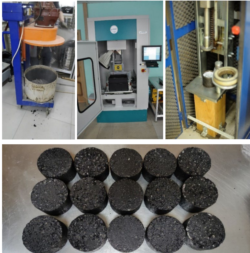
Рис. 3. Изготовление асфальтобетонных образцов Fig. 3. Manufacture of asphalt concrete samples
