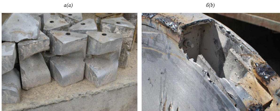
Рис. 1. Изношенный отбойный элемент (а); разрушение лопасти и диска ускорителя (б) при измельчении асфальтового гранулята
