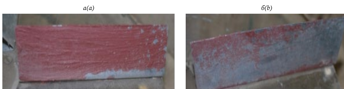
Рис. 5. Следы движения частиц материала по поверхностям наклонных лопастей: a - \beta = 90^\circ ; b - криволинейная Fig. 5. Traces of the movement of material particles on the surfaces of inclined blades: a - \beta = 90^\circ ; b - curved
